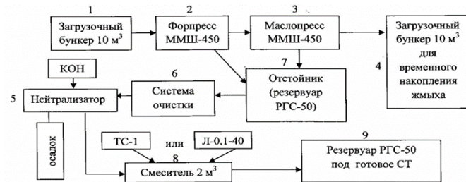
Рисунок 2 – Схема технологической линии производства смесового топлива на основе рапсового масла
